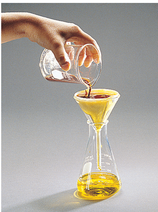
Fig. 1. Filtración por gravedad.
