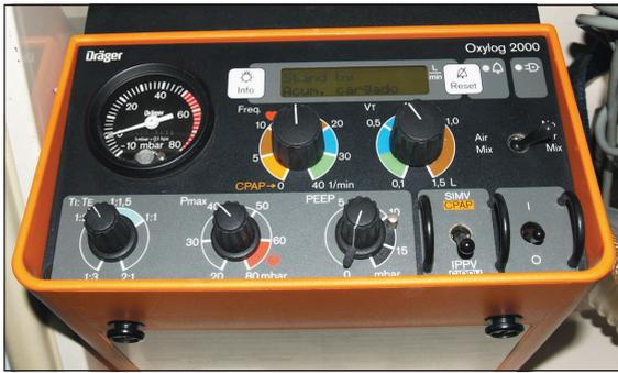
Fig. 16. Respirador de presión o manométrico.
