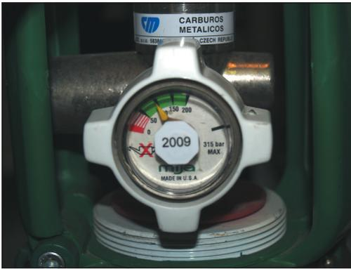
Fig. 5. Manómetro.
