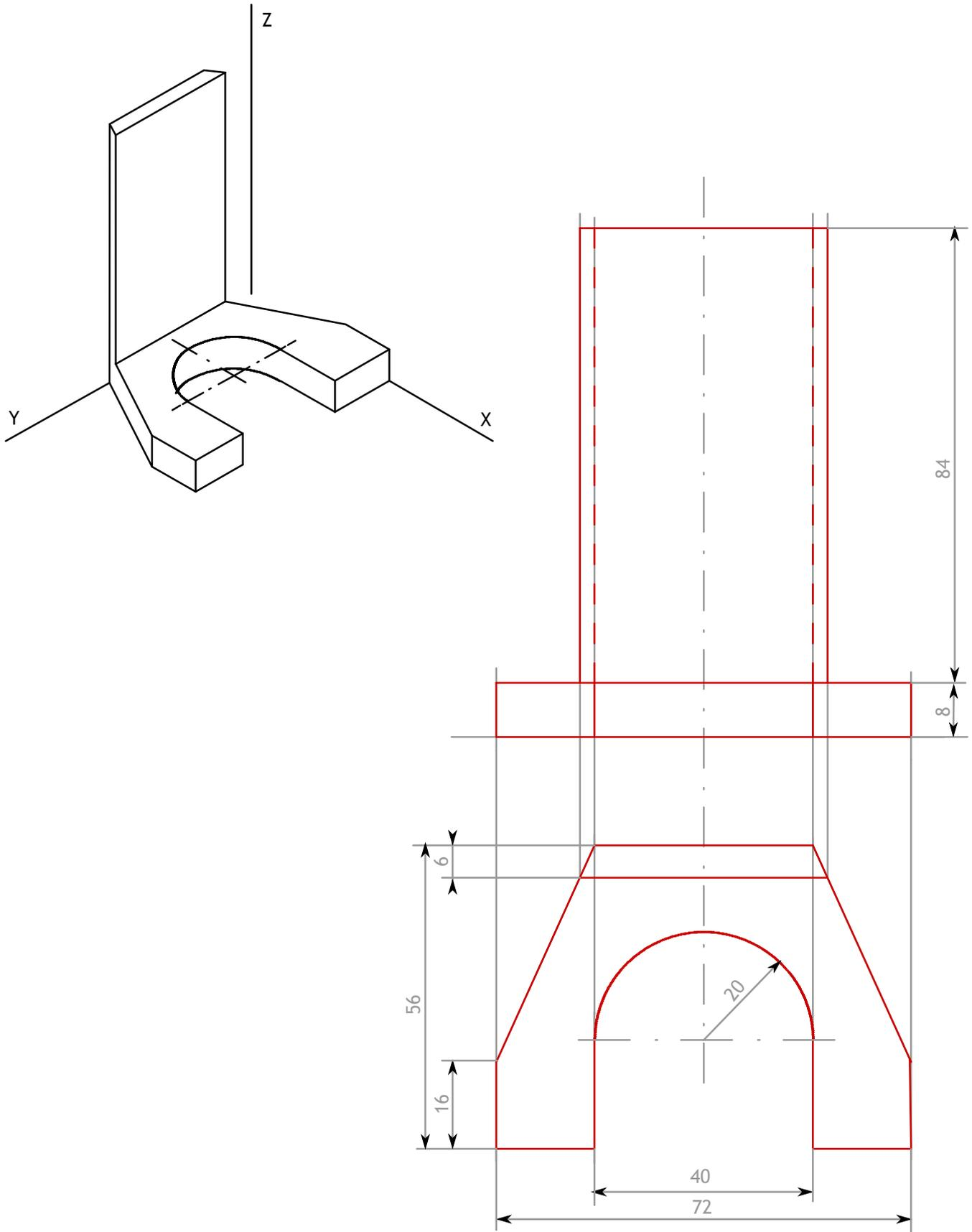
Dada una pieza representada en perspectiva caballera, a escala 1:4, a la que se ha aplicado un coeficiente de reducción de  $\frac{2}{3}$ , se pide:
