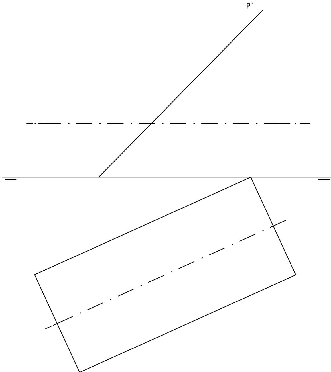
Dadas las proyecciones del eje del cilindro recto de revolución, la proyección horizontal del mismo y la traza vertical de un plano perpendicular al primer bisector, se pide:
