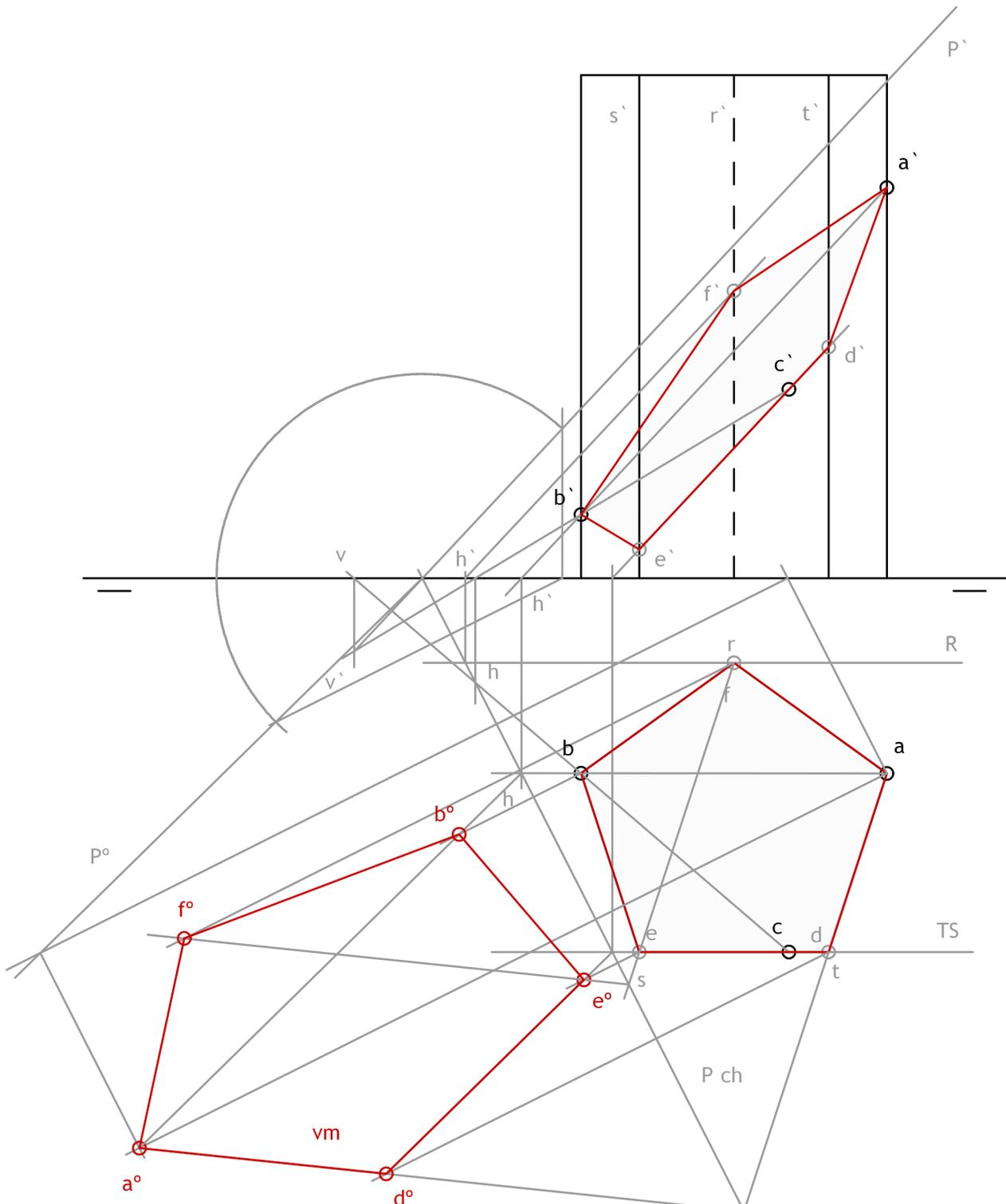
Dadas las proyecciones de la base de un hexaedro ABCD y las proyecciones de las rectas R y S que se cortan en el punto E, se pide:
