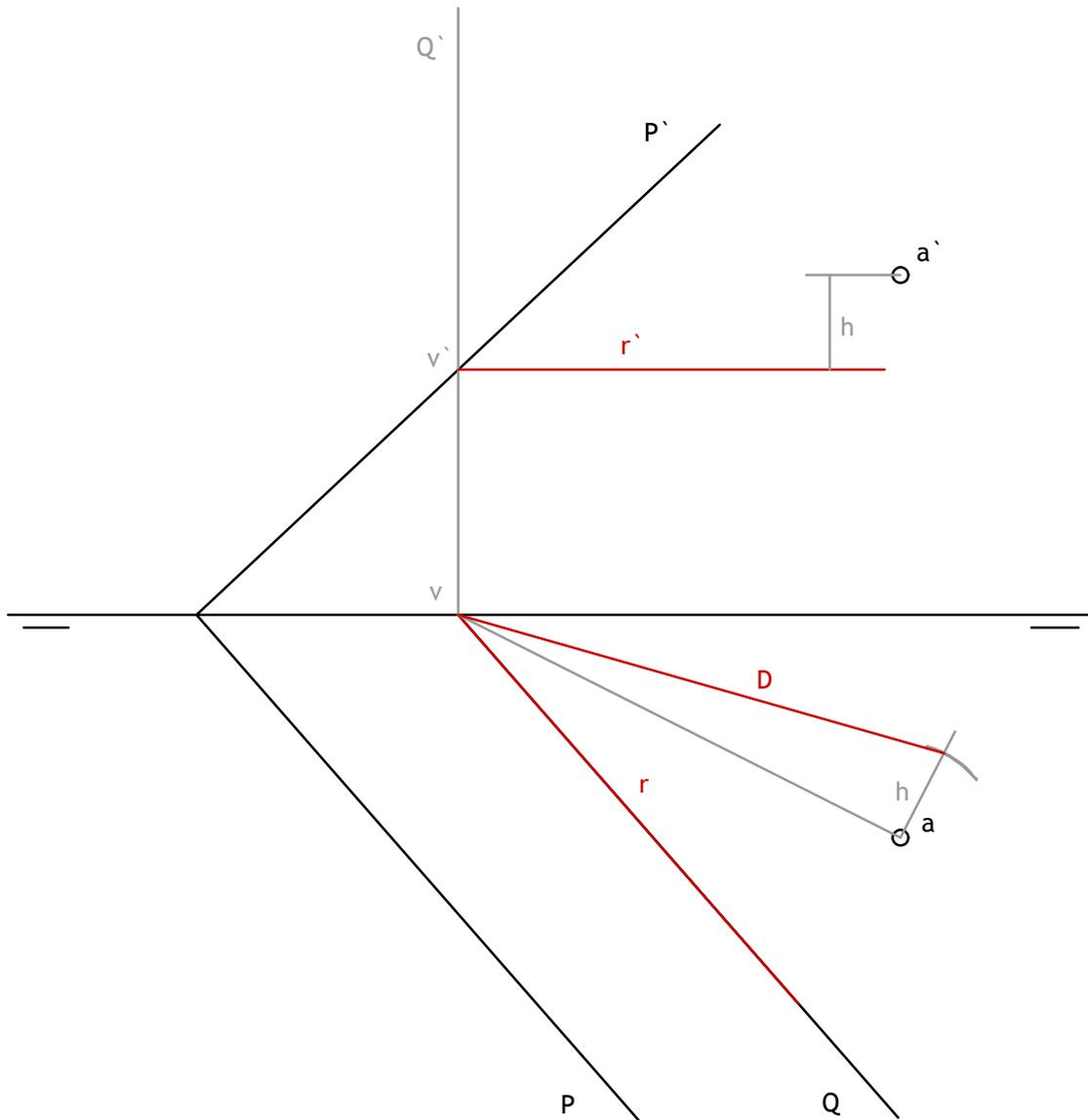
De un plano P conocemos su traza horizontal y su traza vertical abatida sobre el plano horizontal de proyección, y de un plano Q conocemos una recta R de máxima inclinación.
