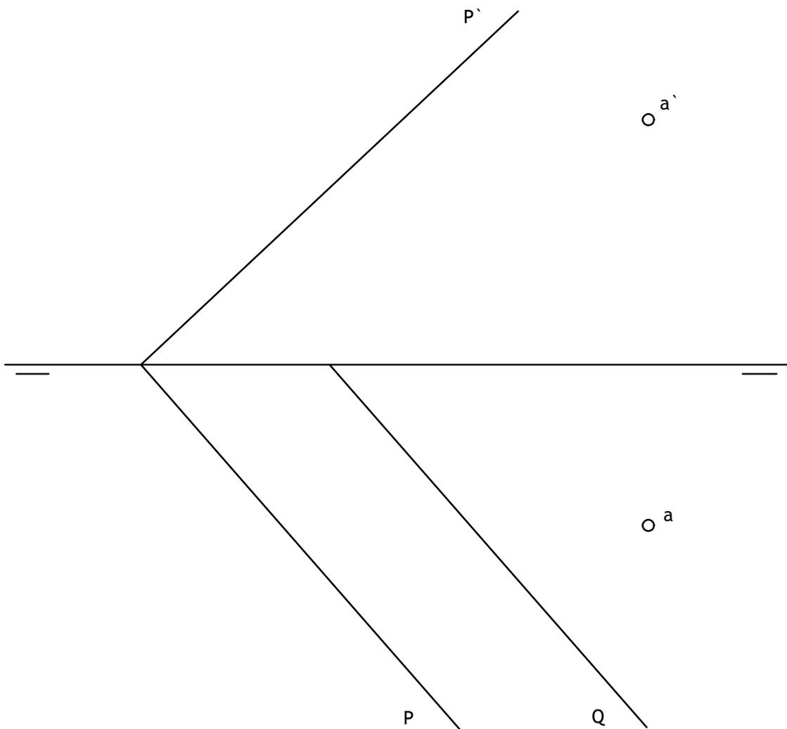
Dadas las trazas del plano P y la traza horizontal del plano proyectante Q, así como las proyecciones del punto A, se pide:
