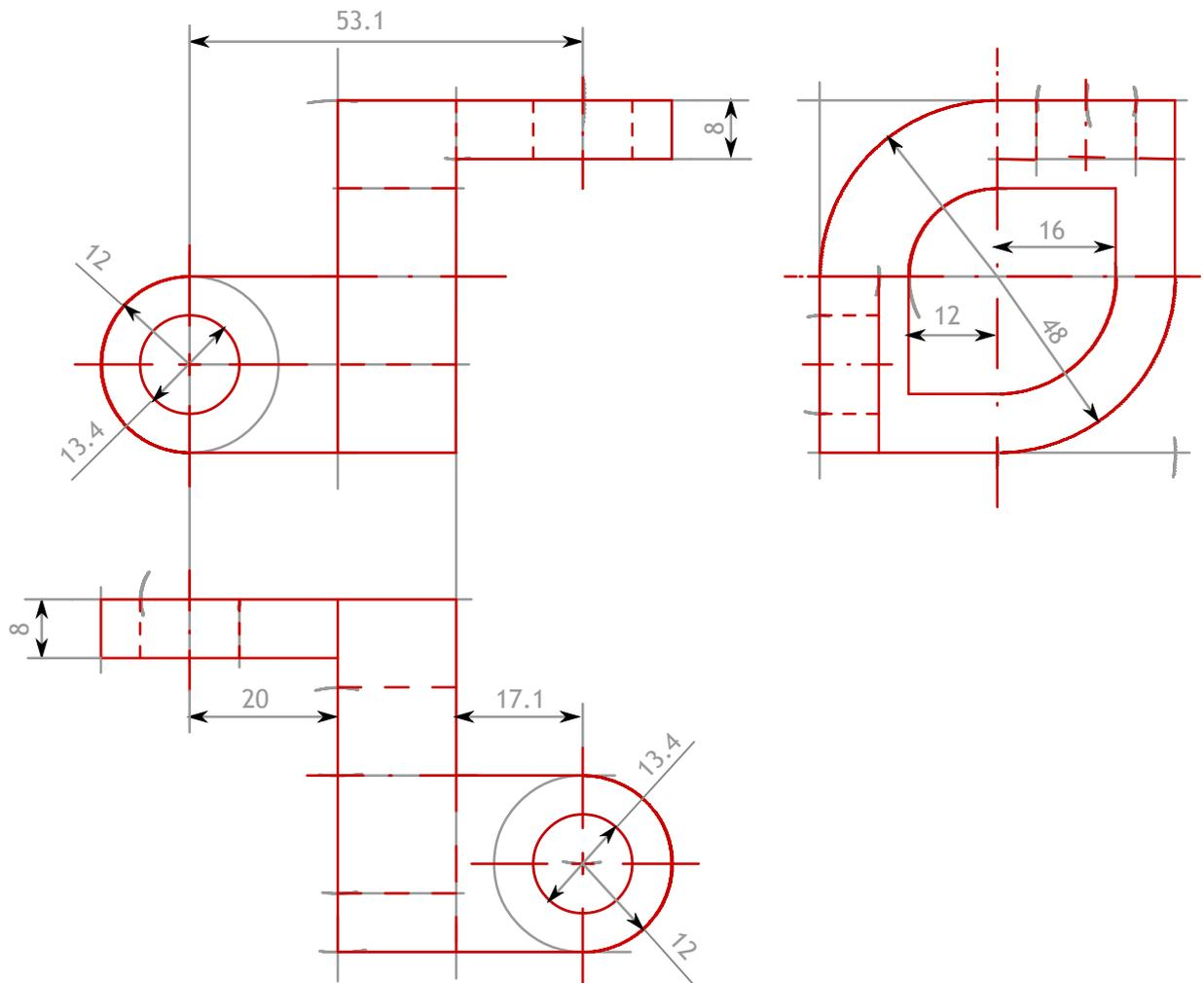
Dados el alzado y la planta de una pieza según el método de representación del primer diedro de proyección, a escala 2:3, se pide:
