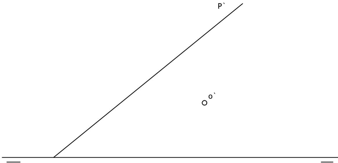
Dada la traza vertical de un plano P perpendicular al primer bisector y la proyección vertical  $o'$  del baricentro de un triángulo equilátero contenido en el plano P, se pide:
