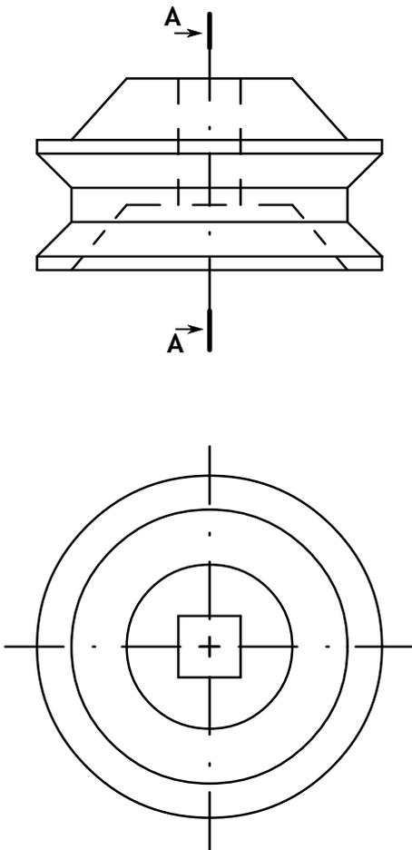
Definida una pieza por dos de sus vistas, según el método del primer diedro de proyección, a escala 1:20, se pide:
