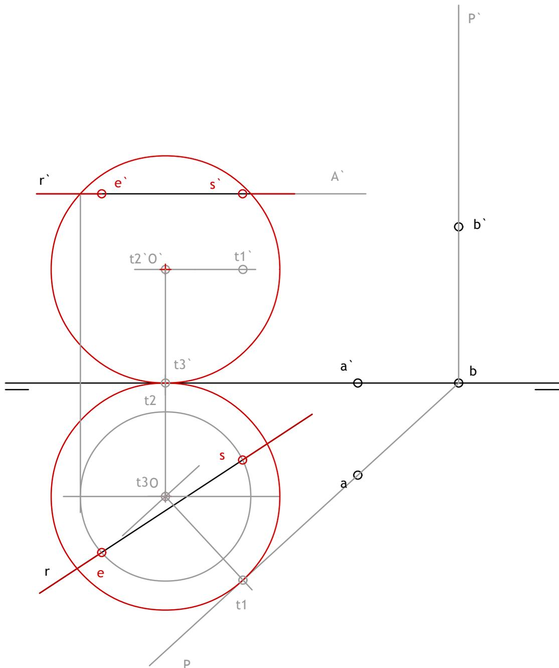
Dadas la proyección horizontal de un cono de revolución apoyado en el plano horizontal de proyección y las trazas de un plano proyectante P, se pide:
