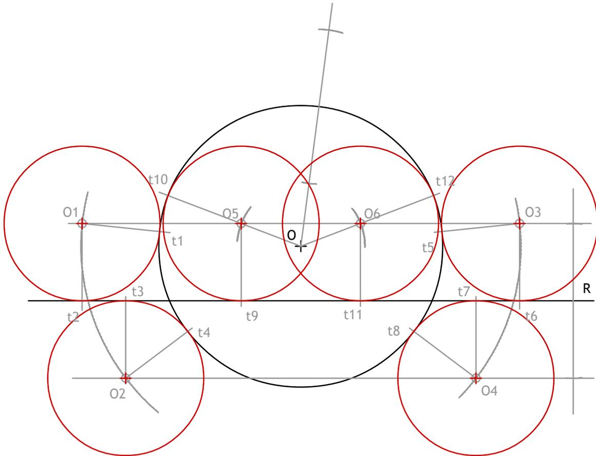
Las semirectas R y S representan dos carreteras que se quieren enlazar mediante dos arcos de circunferencia de igual radio a partir de los puntos B y C de ambas. Se pide:
