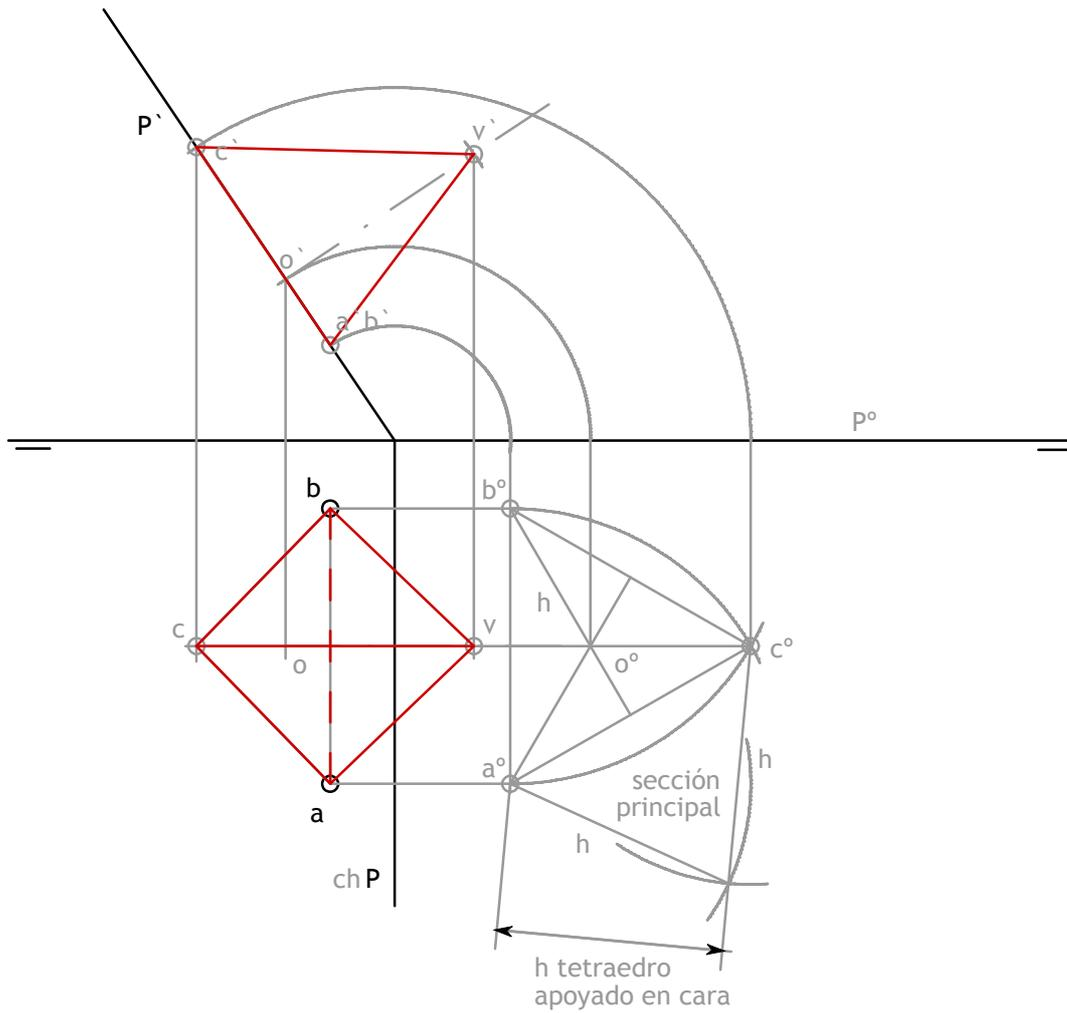
Dadas las proyecciones del triángulo ABC, se pide representar las proyecciones de la pirámide de base ABC y altura 8 cm, sabiendo que el vértice V de la pirámide se proyecta ortogonalmente sobre su base en el circuncentro.
