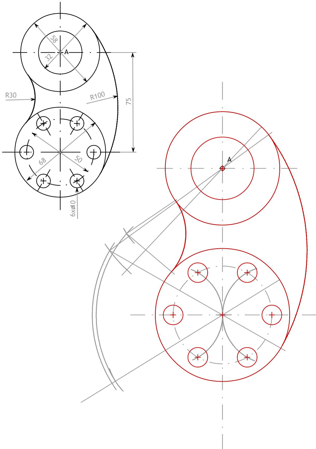
Dibujar a escala 1:1 la figura representada (arandela pivotante), obteniendo los centros y los puntos de tangencia necesarios. Comenzar la construcción a partir del punto A.
