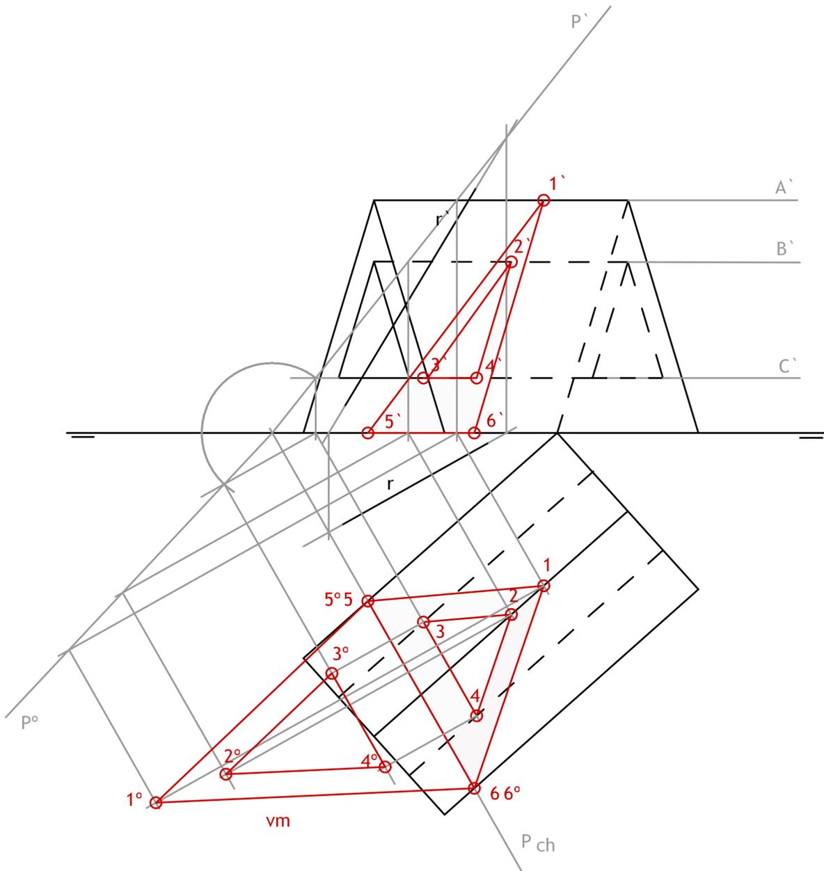
Hallar la intersección del prisma dado por sus proyecciones diédricas con el plano P`P y obtener la sección en verdadera forma y magnitud.
