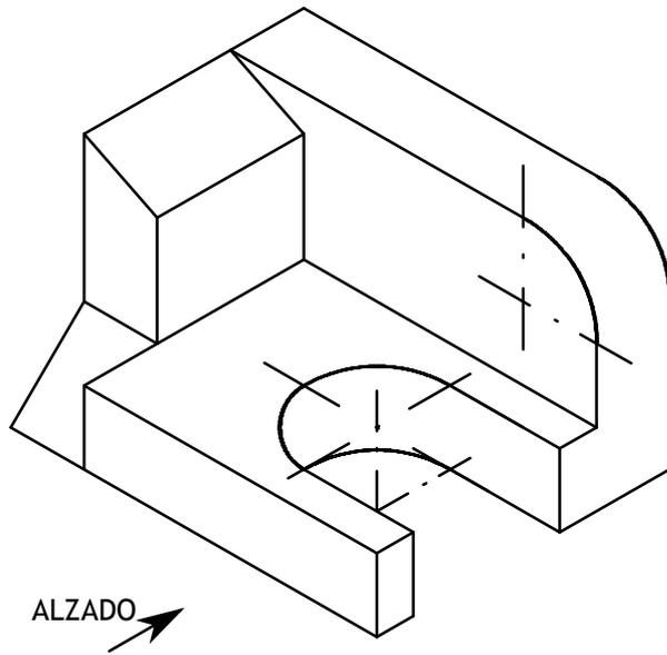
Dado el dibujo isométrico de una pieza (sin emplear el coeficiente de reducción) a escala 1:2, se pide dibujar a escala 3:5 el alzado, la planta y el perfil de la pieza dada (método del primer diedro).
