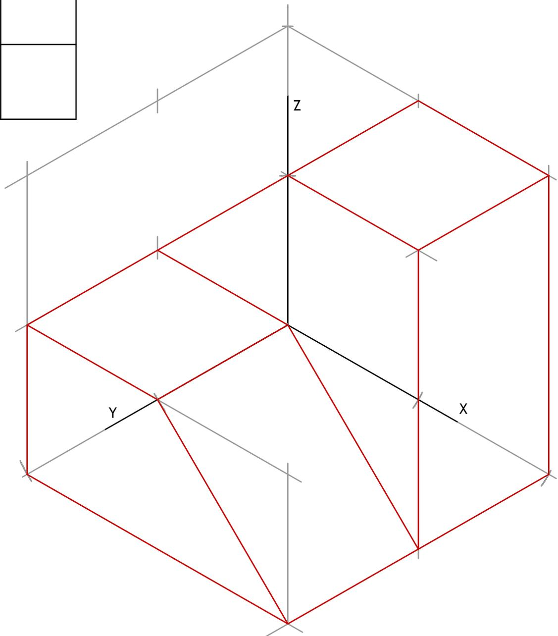
Dados el alzado y el perfil izquierdo de una pieza según el método de representación del primer diedro de proyección, a escala 3:4, se pide representar su perspectiva isométrica a escala 3:2, según los ejes dados, indicando líneas vistas y ocultas.
