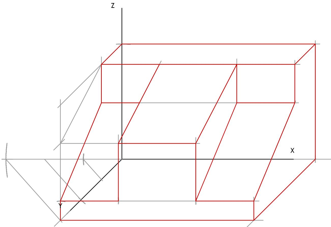
Dados alzado, planta y perfil derecho de una pieza a escala 1:2, según el método de representación del primer diedro de proyección, se pide dibujar la perspectiva caballera de la pieza a escala 1:1, según los ejes dados, con coeficiente de reducción de valor 2/3.
