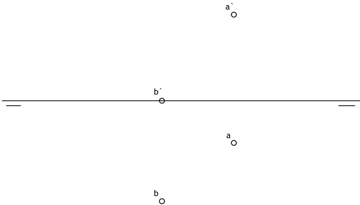
Los puntos A y B, vértices de un cubo, son los extremos de una de las diagonales de la base. Dicha diagonal es además línea de máxima pendiente del plano donde se apoya dicho poliedro. Se pide:
