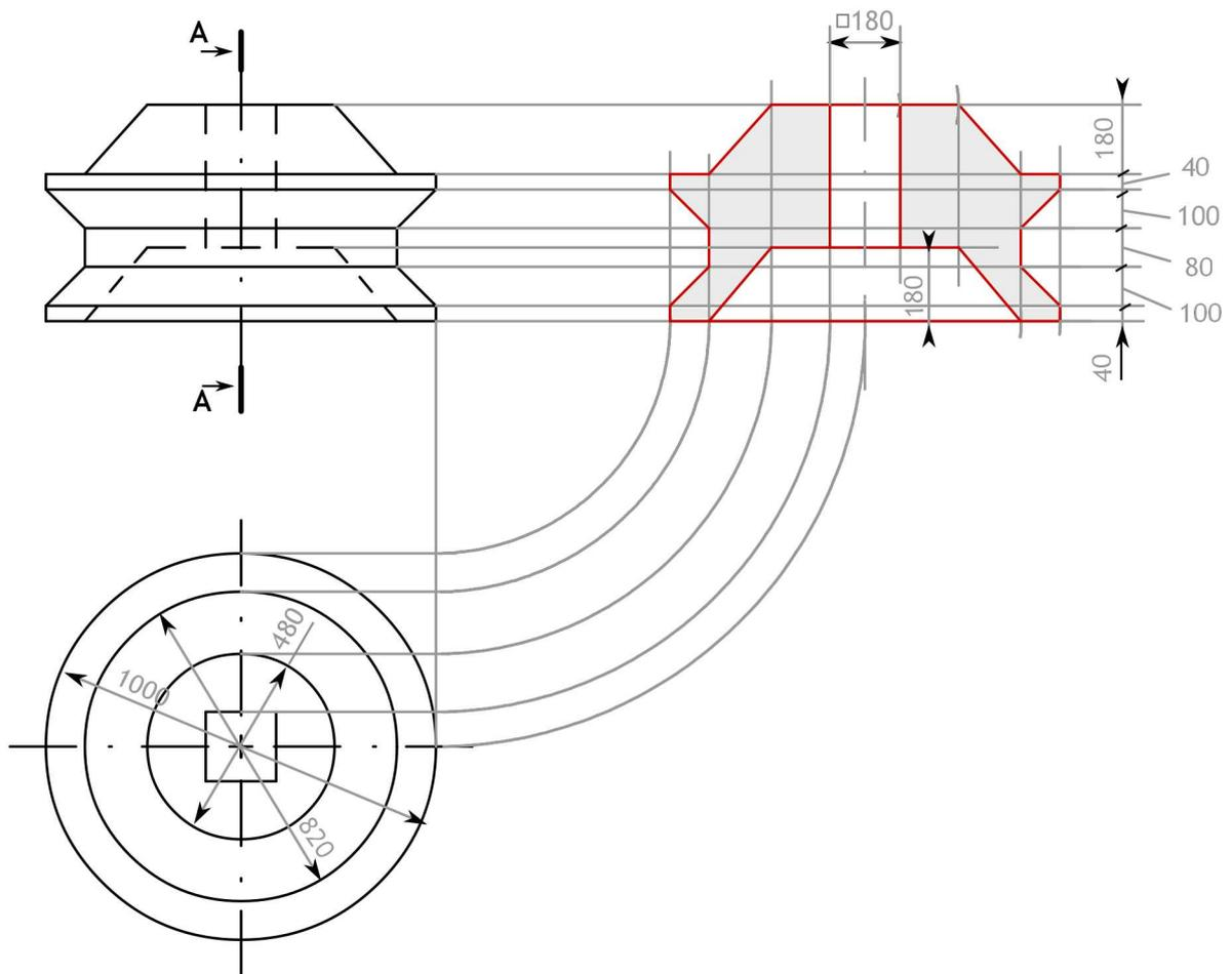
Dados alzado y planta de una pieza a escala 1:2 según el método de representación del primer diedro de proyección, se pide:
