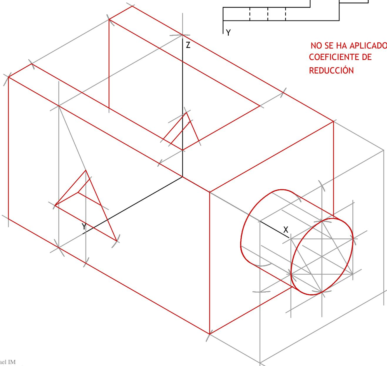
Dados el alzado y el perfil izquierdo de un sólido, según el método de representación del primer diedro de proyección, a escala 1:2, se pide:
