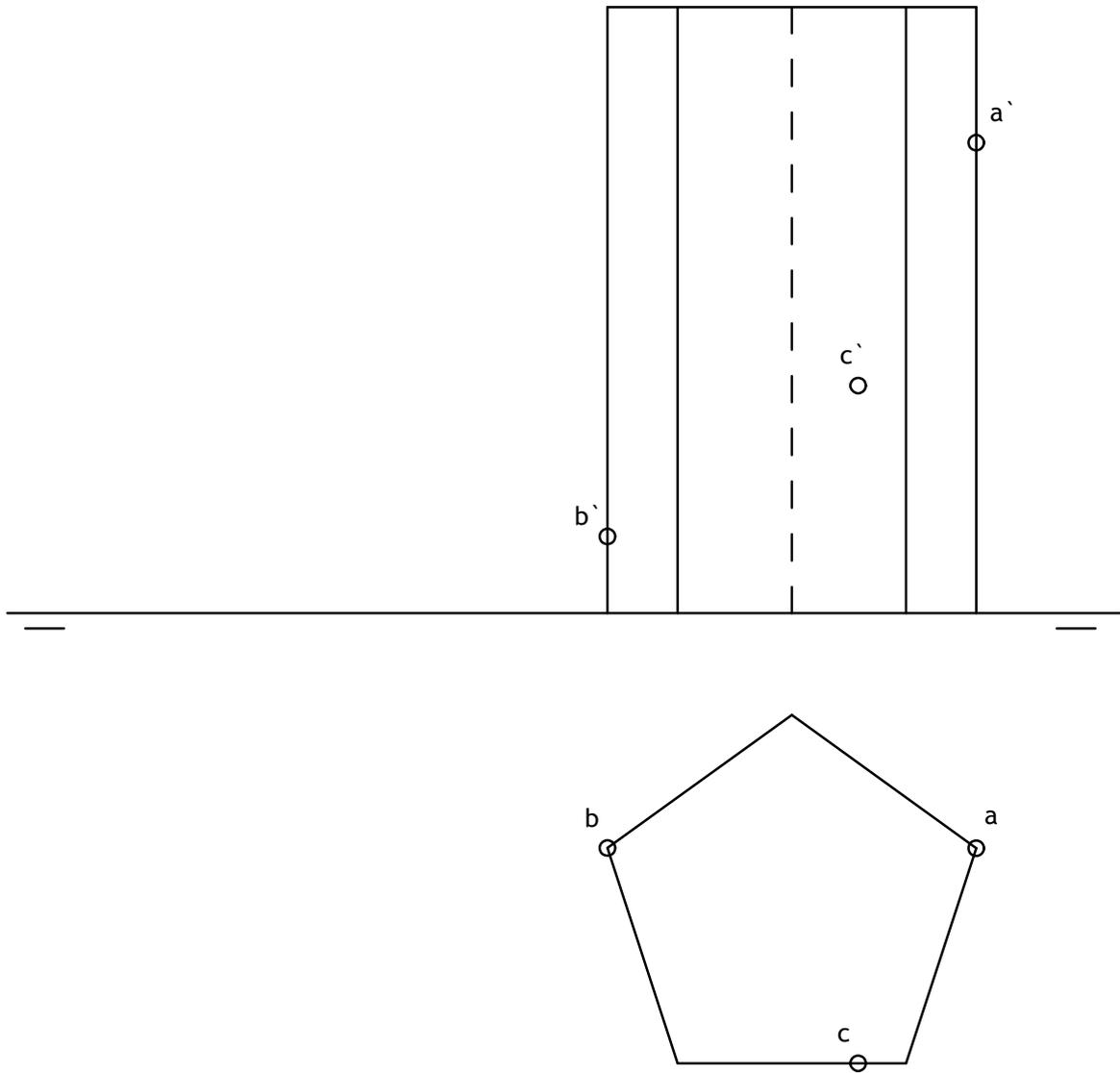
Conocidas las proyecciones de un prisma regular de base pentagonal y las de los puntos A, B y C, se pide:
