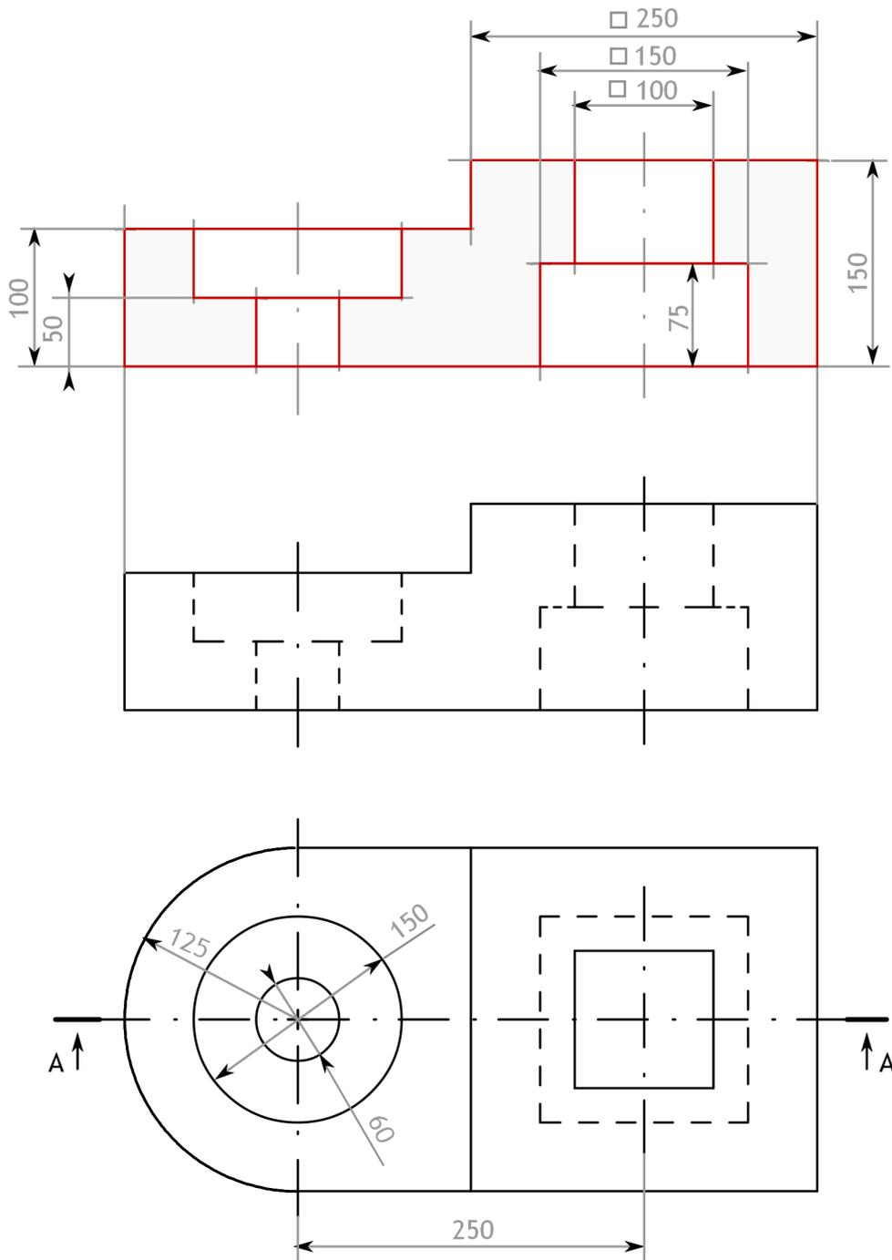
Dados el alzado y la planta de una pieza a escala 5:2, según el método de representación del primer diedro de proyección, se pide:
