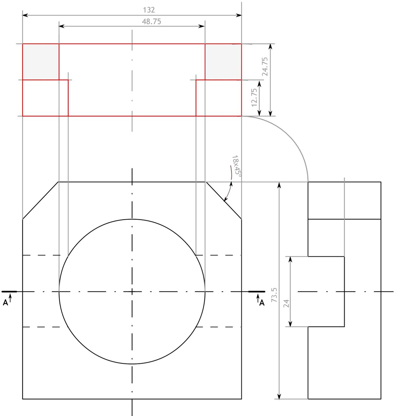
Definida una pieza por dos de sus vistas, según el método del primer diedro de proyección, a escala 1:20, se pide:
