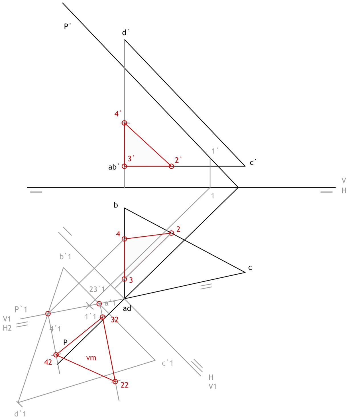
Dadas las proyecciones del eje del cilindro recto de revolución, la proyección horizontal del mismo y la traza vertical de un plano perpendicular al primer bisector, se pide:
