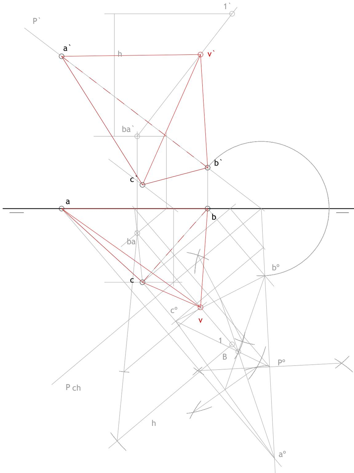
Los puntos A y B, vértices de un cubo, son los extremos de una de las diagonales de la base. Dicha diagonal es además línea de máxima pendiente del plano donde se apoya dicho poliedro. Se pide:
