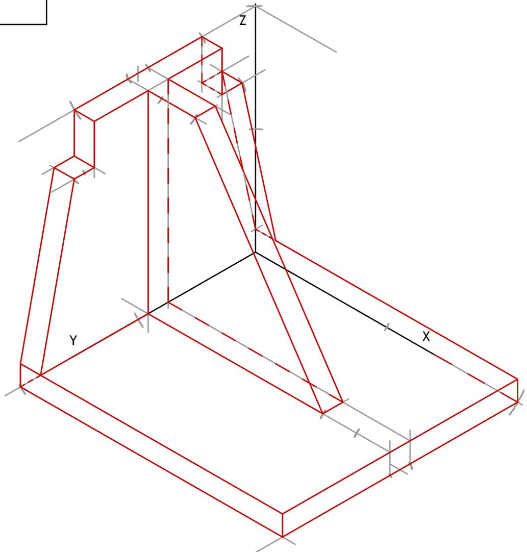
Realizar la perspectiva isométrica a escala 1:5 de la torre definida por sus vistas convencionales en el sistema de proyección del primer diedro a escala 1:10.
