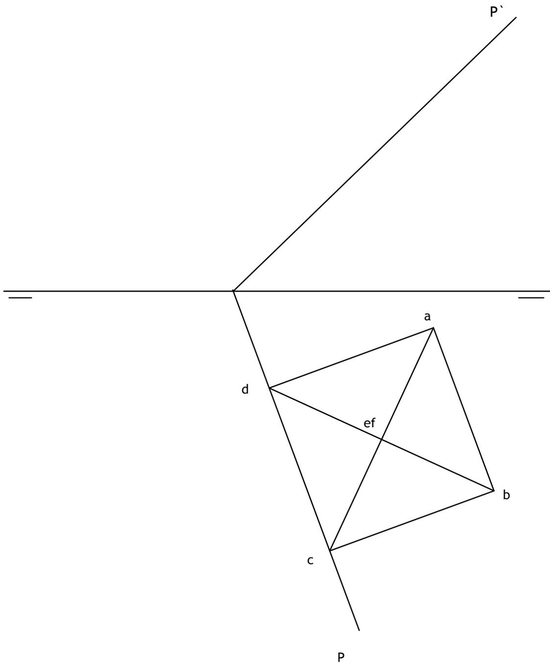
Dada la proyección horizontal de un octaedro regular, apoyado por un vértice en el plano horizontal de proyección, y las trazas de un plano P, se pide:
