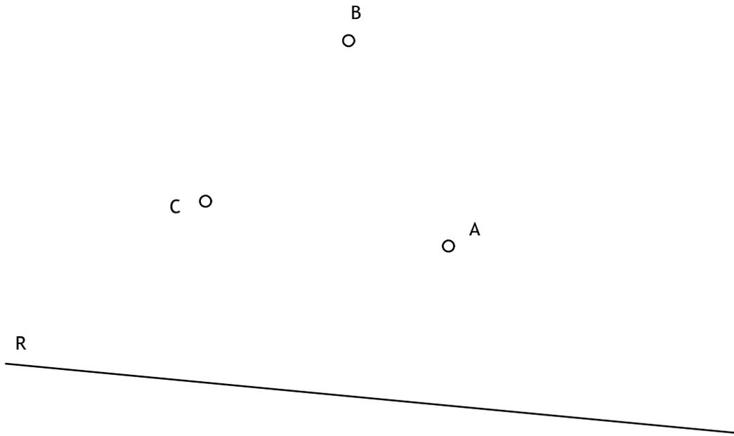
Dibujar los arcos de circunferencia tangentes a la recta R y a la circunferencia definida por los puntos A,B y C, en el punto A, determinando geométicamente los centros y los puntos de tangencia con la recta R.
