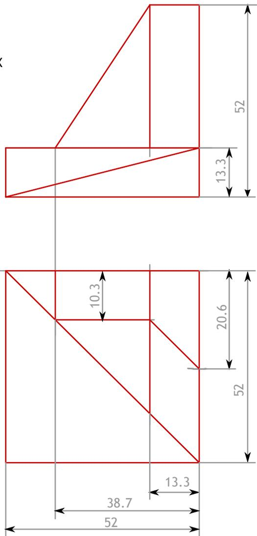
Dado un sólido representado en dibujo isométrico, a escala 3/4, se pide:
