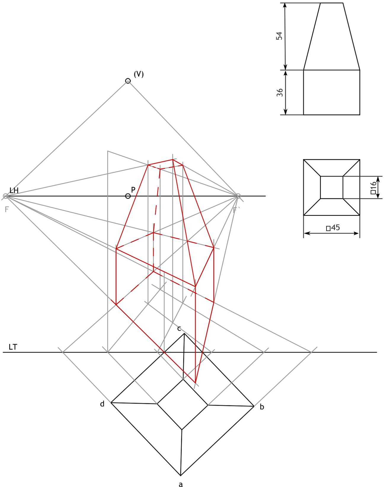
Definido el sistema cónico por la línea de tierra L.T., la línea de horizonte L.H., el punto principal P y el abatimiento sobre el plano del cuadro del punto de vista (V), se pide dibujar la perspectiva cónica a escala 2:1 del sólido dado por sus vistas a escala 1:1 según el sistema de representación del primer diedro de proyección, sabiendo que dicha figura está apoyada en el plano geometral, en el posición indicada en el abatimiento de su planta sobre el plano del cuadro.
