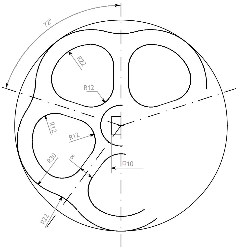
Completar a E= 1/1 el volante representado en la figura.
