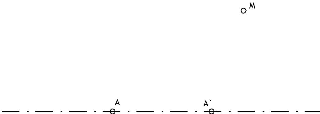
De una hipérbola equilátera se conoce el eje real, los vértices  $A$  y  $A'$  y un punto  $M$  de una asíntota. Se pide:
