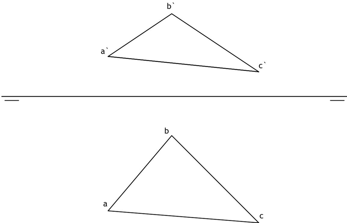
Dadas las proyecciones del triángulo ABC, se pide representar las proyecciones de la pirámide de base ABC y altura 8 cm, sabiendo que el vértice V de la pirámide se proyecta ortogonalmente sobre su base en el circuncentro.
