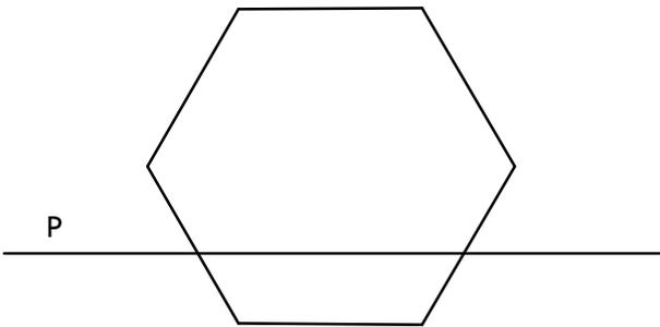
Conocidas la proyección horizontal de la base hexagonal de un prisma regular apoyado sobre el plano horizontal de proyección, cuya altura es 40 mm, y las trazas de un plano P, se pide:
