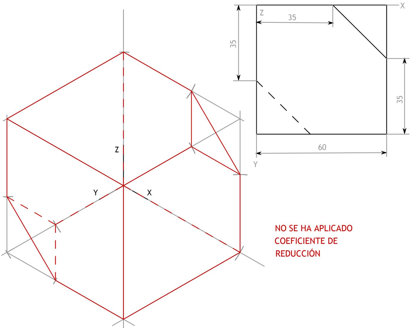
Se define una pieza por su alzado, planta y perfil derecho en el sistema de proyección del primer diedro, a escala 1:1. Se pide representar su perspectiva isométrica, según los ejes dados, a escala 2:1.
