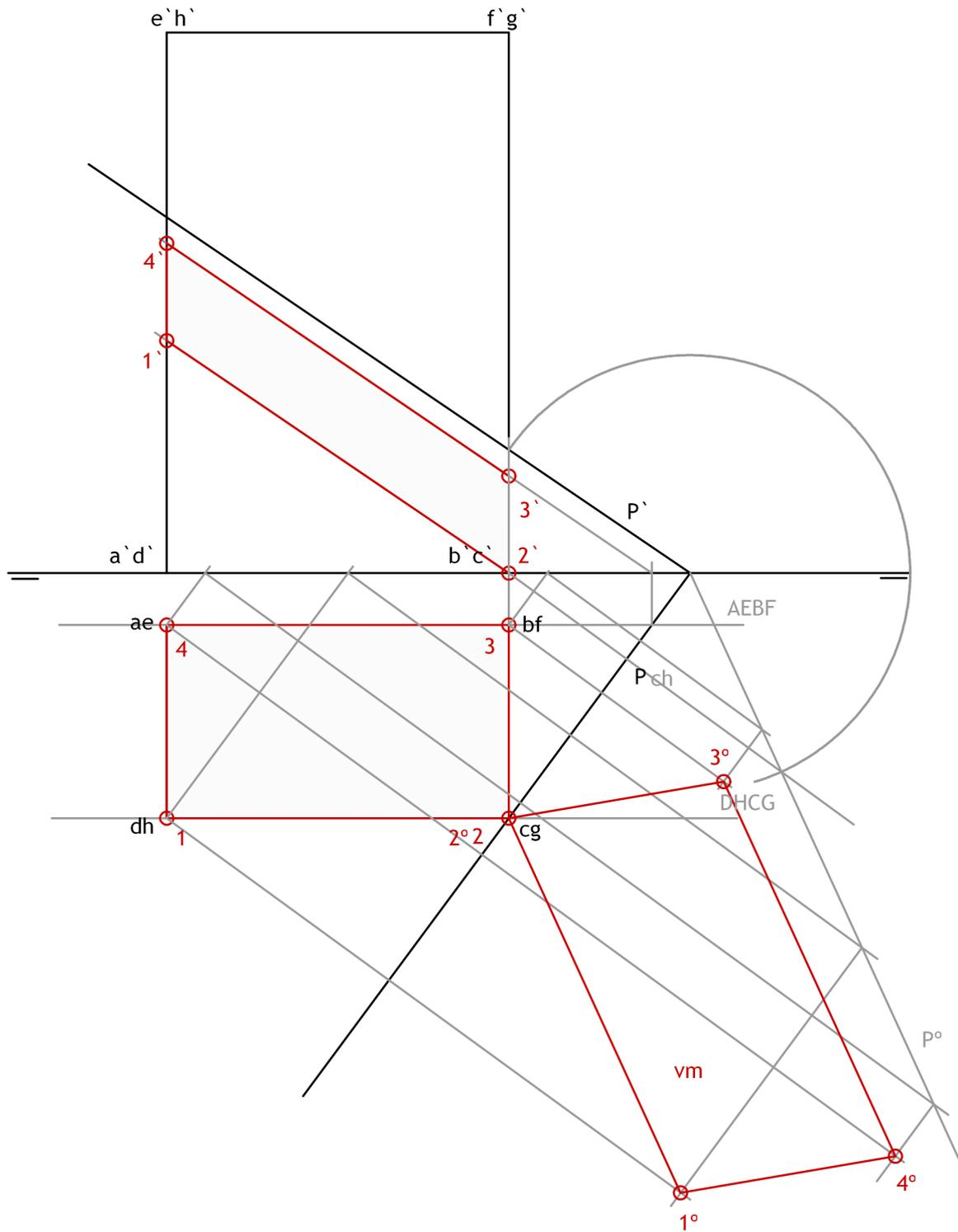
Hallar la intersección del cubo representado por sus proyecciones diédricas con el plano P'P y obtener la sección en verdadera forma y dimensiones.
