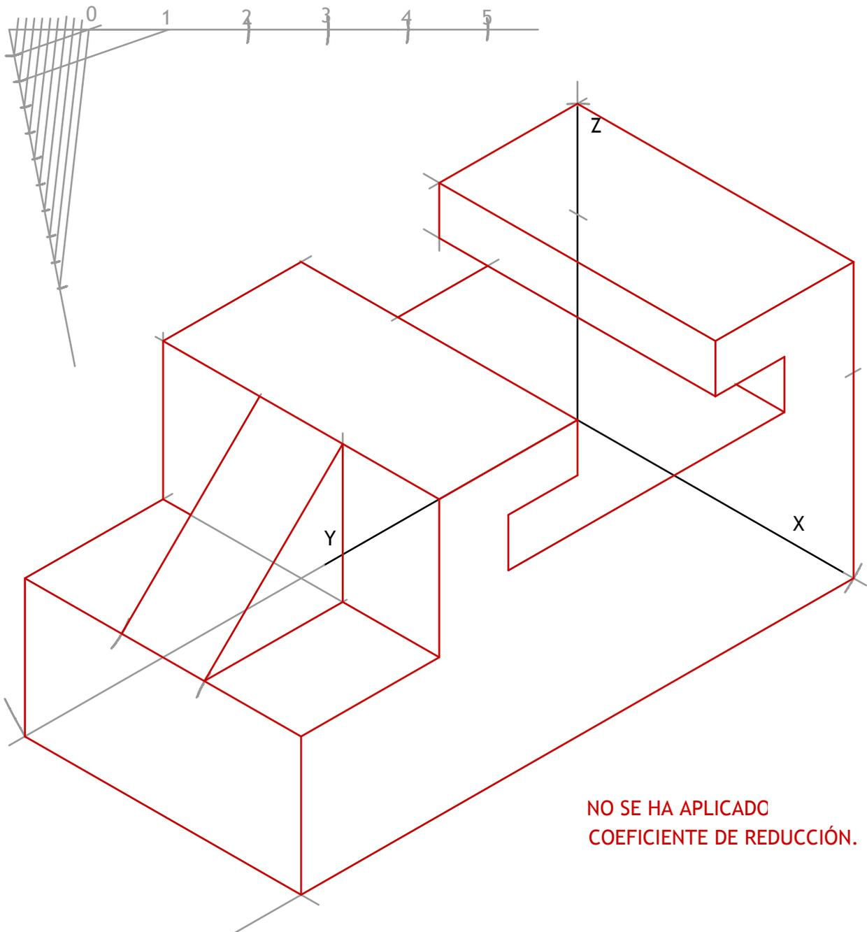
Dados el alzado, la planta y el perfil izquierdo de una pieza según el sistema de representación del primer diedro de proyección a escala 2:5, representar su perspectiva isométrica a escala 1:1, según los ejes dados:
