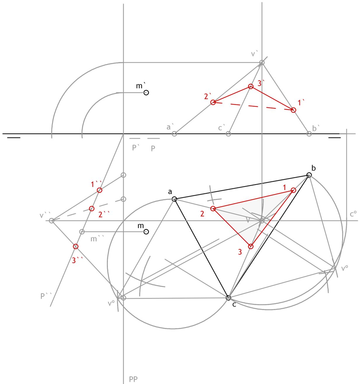
Dada la proyección horizontal de un octaedro regular, apoyado por un vértice en el plano horizontal de proyección, y las trazas de un plano P, se pide:
