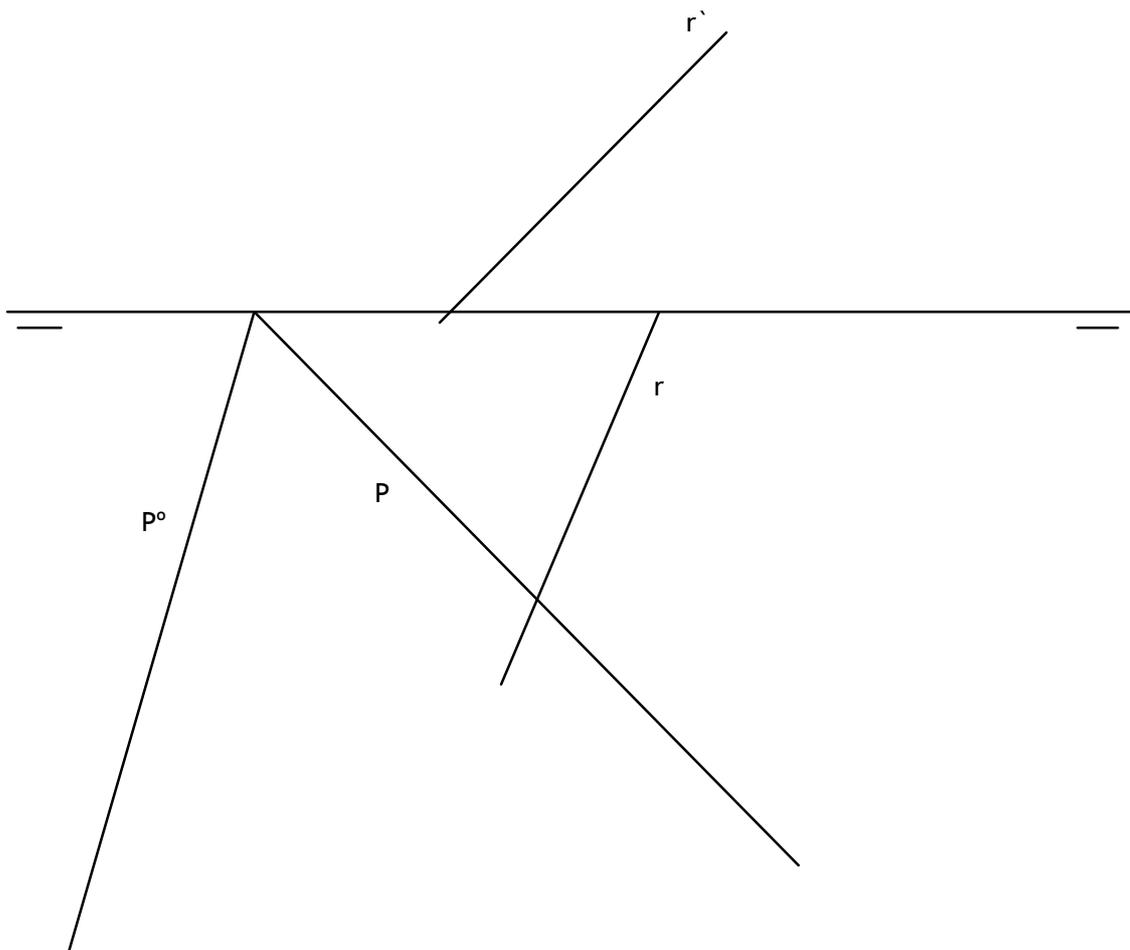
De un plano P conocemos su traza horizontal y su traza vertical abatida sobre el plano horizontal de proyección, y de un plano Q conocemos una recta R de máxima inclinación.
