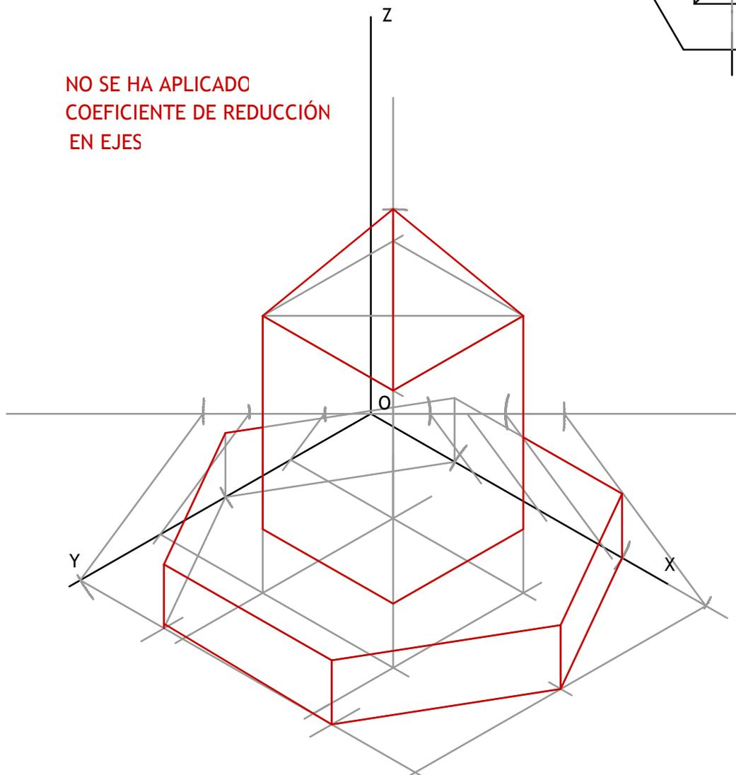
Dados el alzado y el perfil izquierdo de una pieza según el sistema de representación del primer diedro de proyección a escala 1:1, representar su perspectiva isométrica a escala 3:2
