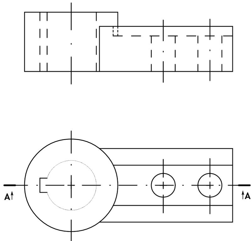
Dados alzado y planta de una pieza a escala 1:2 según el método de representación del primer diedro de proyección, se pide:
