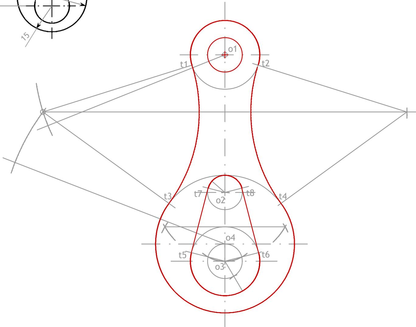
Dibujar a escala 4:3 la pieza acotada dada, dejando constancia de los trazados geométricos empleados para determinar los centros de tangencia de los diferentes arcos de enlace. No es necesario poner las cotas.
