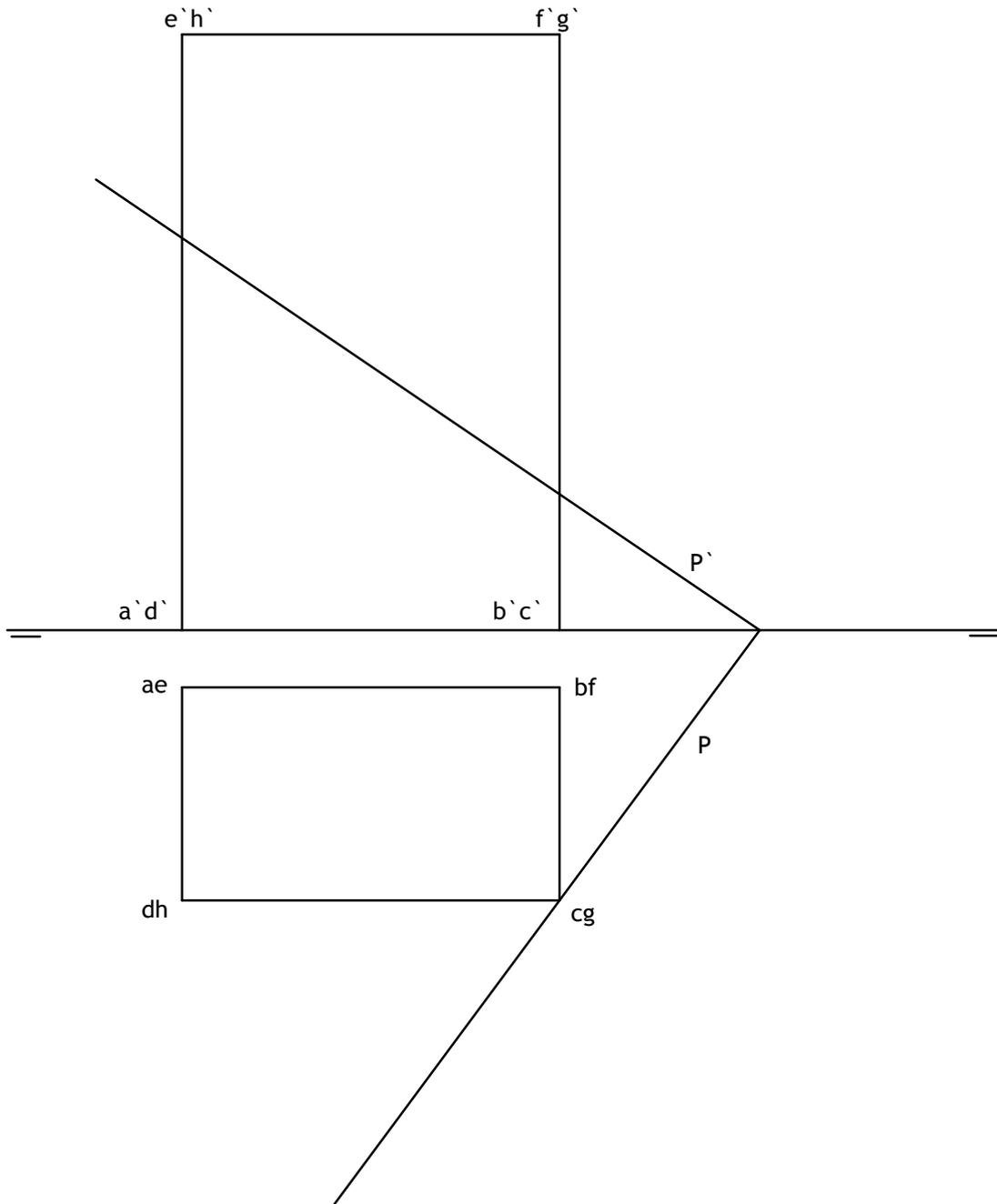
Hallar la intersección del prisma dado por sus proyecciones diédricas con el plano P`P y obtener la sección en verdadera forma y magnitud.
