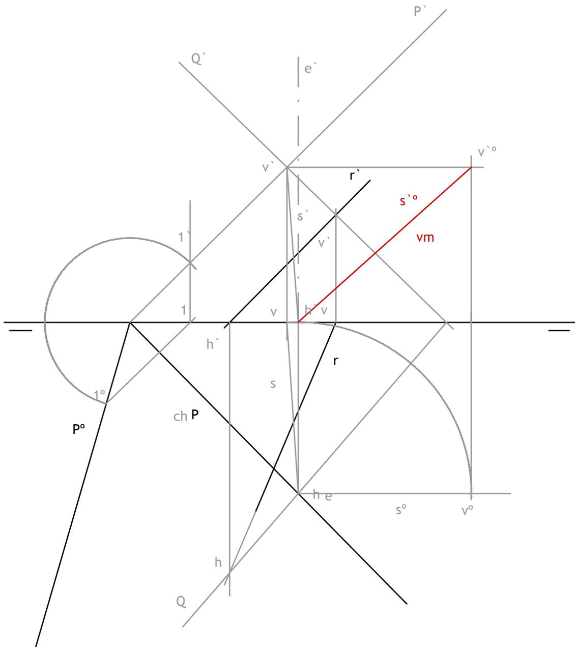
Dada la traza horizontal del plano P y las proyecciones de una recta R contenida en él, se pide:
