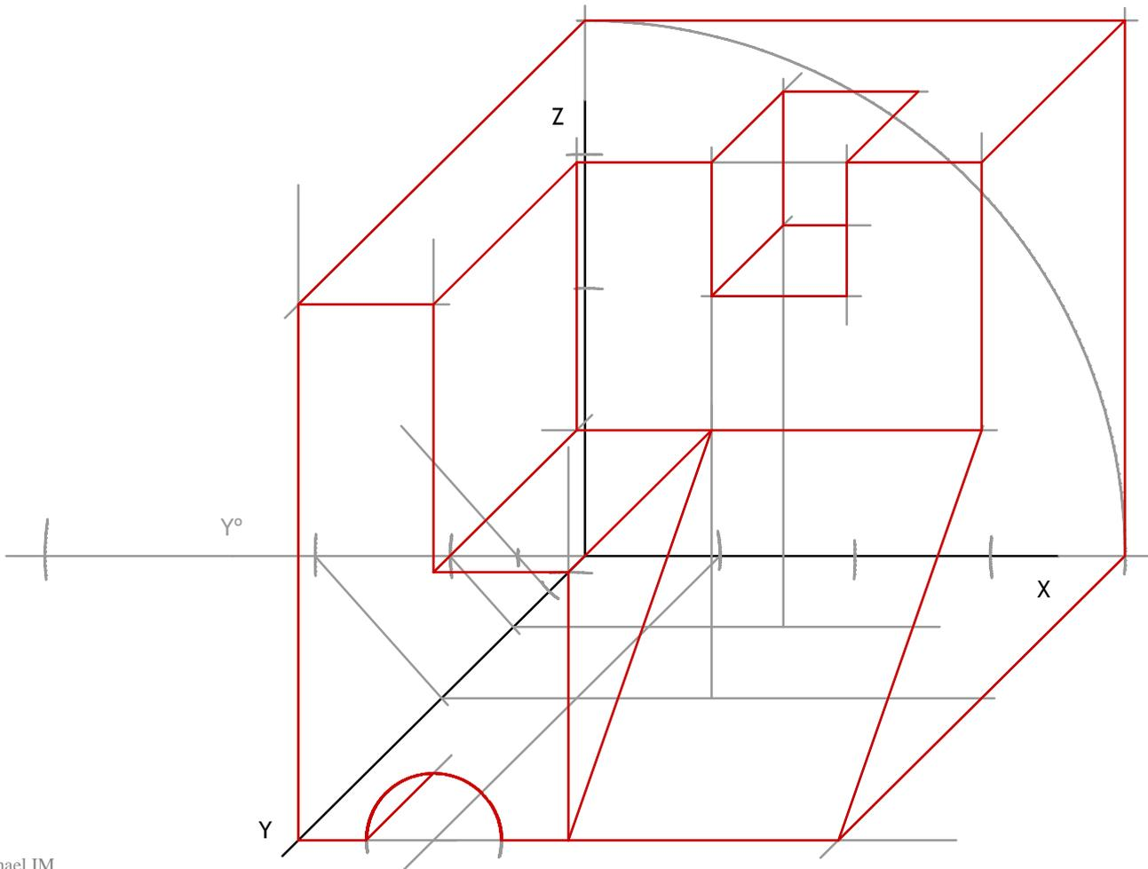
Representar el alzado, planta y perfil derecho de una pieza según el método de representación del primer diedro de proyección a escala 1:2, se pide dibujar su perspectiva caballera a escala 1:1, en el sistema de ejes indicados, aplicando un coeficiente de reducción de 3/4.
