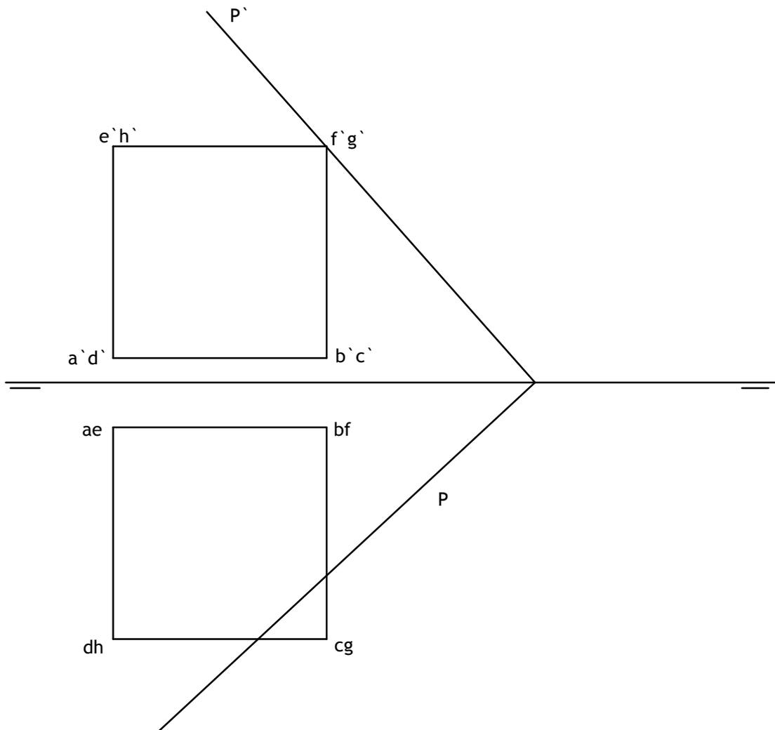
Hallar la intersección del cubo representado por sus proyecciones diédricas con el plano P'P y obtener la sección en verdadera forma y dimensiones.
