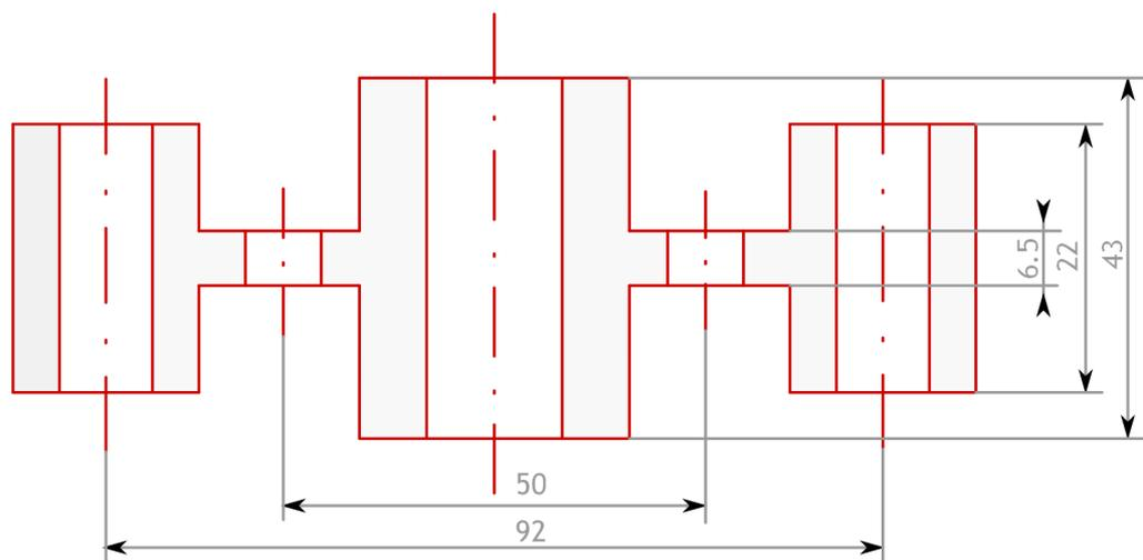
Dadas las vistas de alzado y planta de una pieza según el método de representación del primer diedro de proyección a escala 2:1, se pide:
