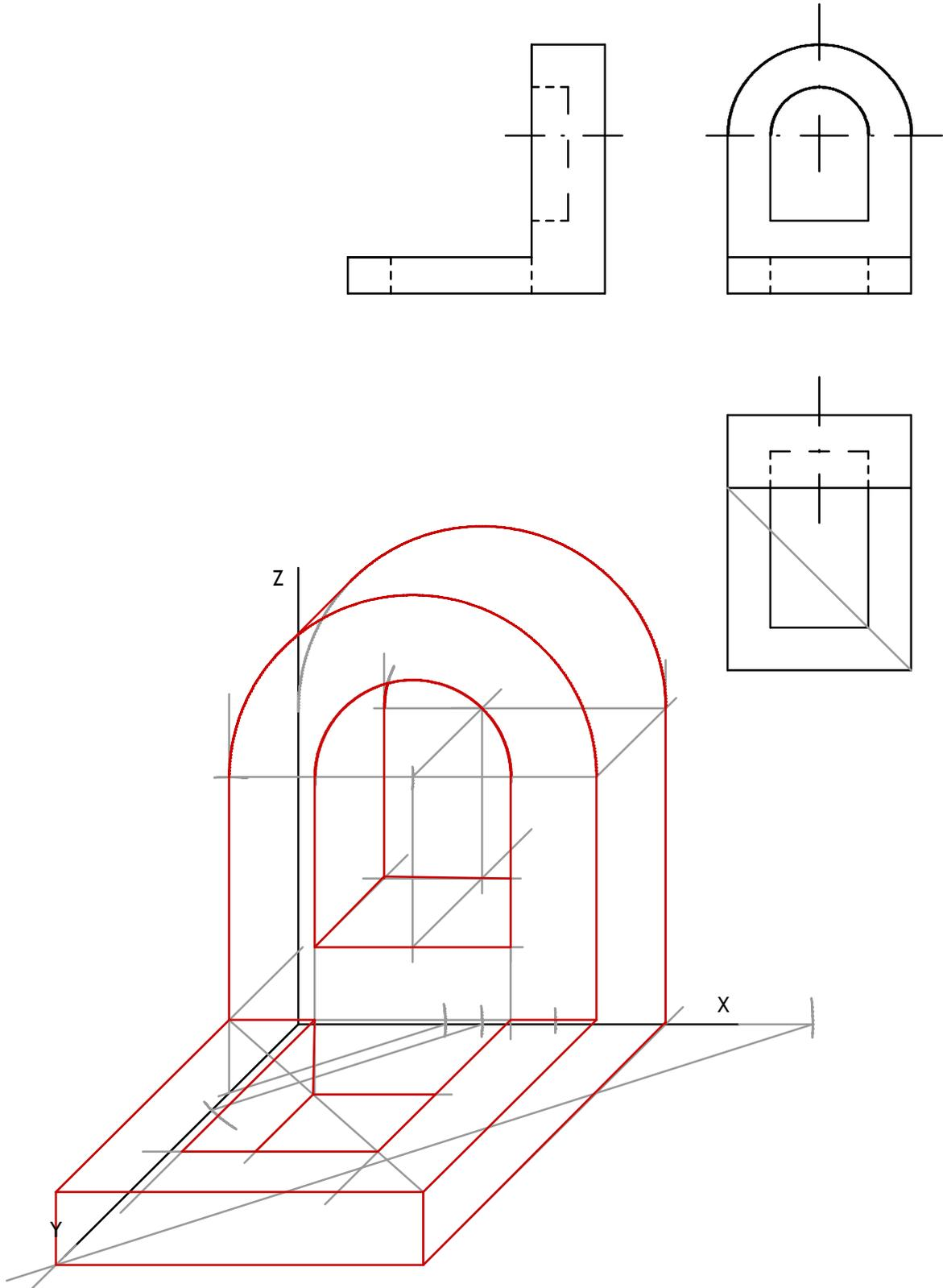
Dados el alzado y la planta, a escala 3:4, representada según el sistema de representación del primer diedro de proyección, se pide dibujar su perspectiva caballera a escala 1:1 según los ejes dados, empleando un coeficiente de reducción de 0.8.
