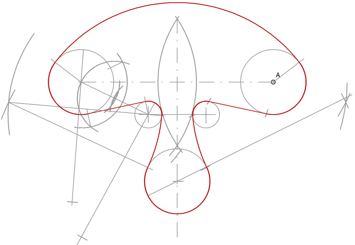
A partir del punto A indicado, dibujar la figura geométrica representada, a escala 2:1, dejando constancia de las construcciones geométricas realizadas y determinando los centros de los arcos y los puntos de tangencia.
