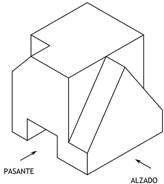
Dado el dibujo isométrico de una pieza (sin emplear el coeficiente de reducción) a escala 1:2, se pide dibujar a escala 3:5 el alzado, la planta y el perfil de la pieza dada (método del primer diedro).
