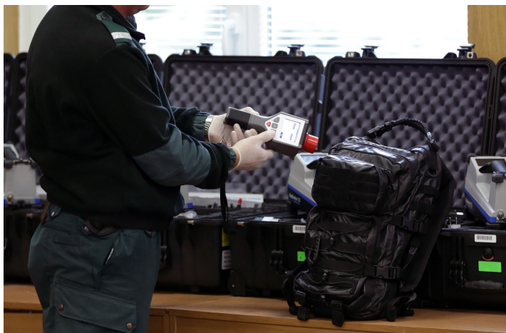
Fig. 7. Detector de neutrones.
