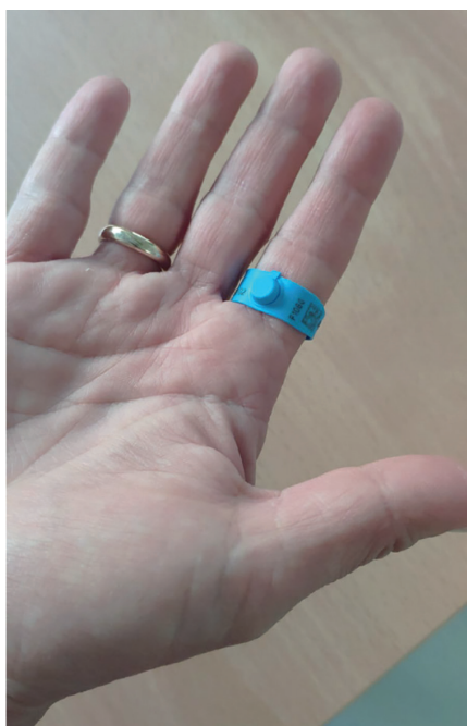
Fig. 3. Dosímetro de anillo para medir el equivalente de dosis personal en las manos.
