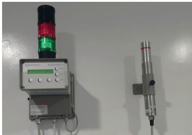
Fig. 4. Monitor de área (cámara de ionización).
