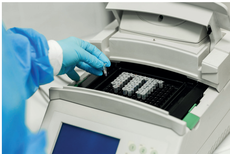
Fig. 1. Termociclador: aparato en el que se lleva a cabo la PCR.
