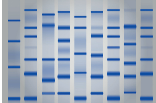
Fig. 6. Electroforesis de proteínas en gel de poliacrilamida. Bandas de proteínas con diferentes pesos moleculares en función de su posición.
