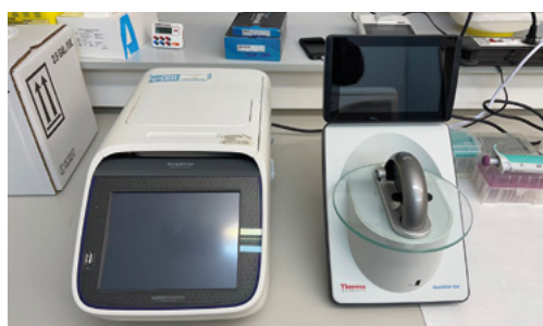
Fig. 4. Termociclador convencional (izquierda) y NanoDrop (derecha).
