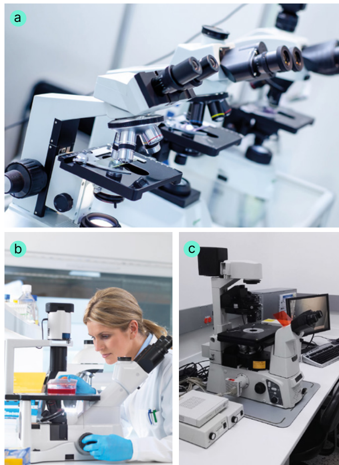
Fig. 2. a) Microscopios ópticos. b) Microscopio invertido. c) Microscopio de fluorescencia.
