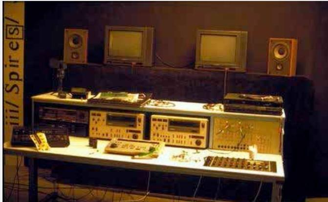
Equipo para la edición lineal con magnetoscopios, monitores, mezclador de audio y de vídeo. Fuente: Wikipedia.
