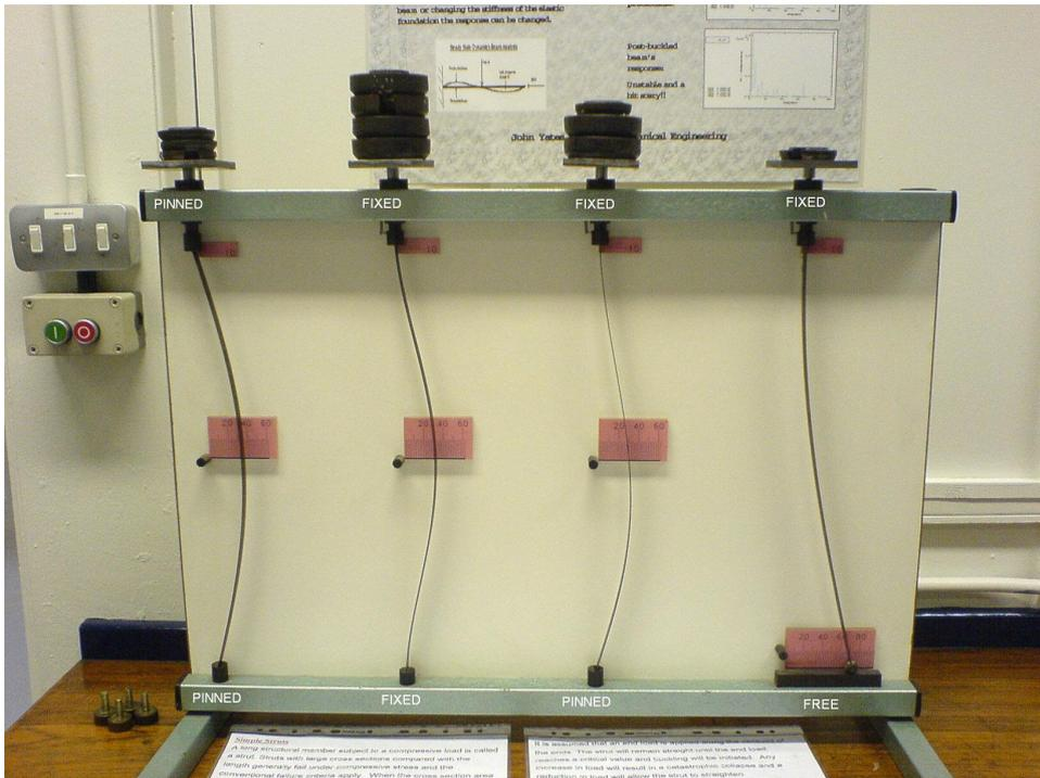
**Figura 2.13** Verificación experimental de carga crítica en columnas con distintas condiciones de contorno. Fuente: "Buckledmodel" by Grahams Child - <http://en.wikipedia.org/wiki/Image:Buckledmodel.JPG>. Licensed under CC BY-SA 3.0 via Wikimedia Commons -
