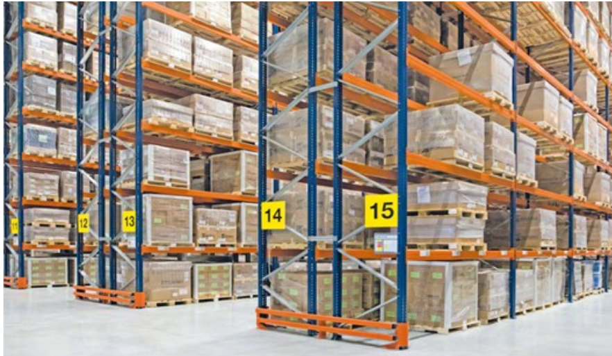
Figura 5. Almacenaje en estanterías convencionales con pasillos. Fuente: Mecalux.
