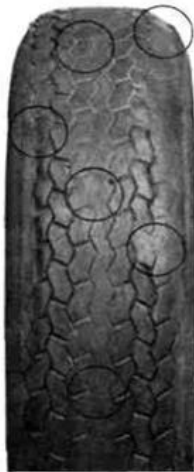
Figura. Desgaste irregular de la cubierta
